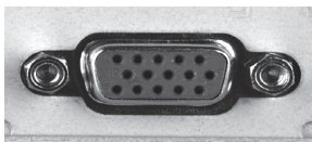
Mini D-Sub15 ピン (Mini D-Sub15-pin)
